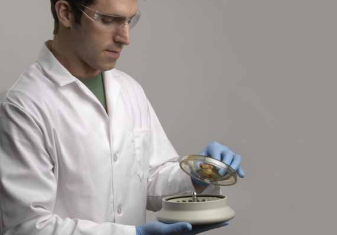
▶ Rotore 24 x 1,5/2,0 ml con coperchio a biocontenimento ClickSeal
